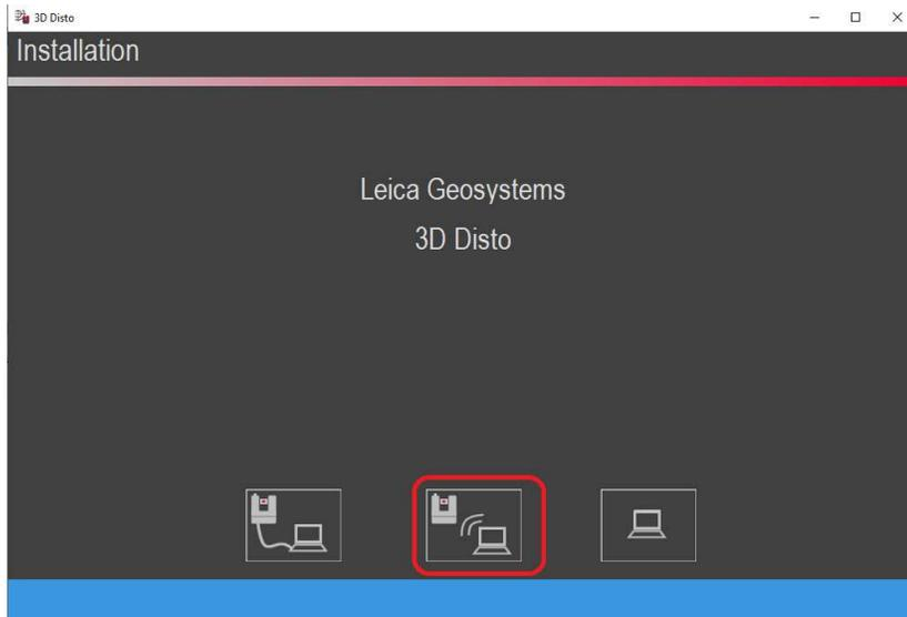
La fenêtre suivante apparaît et la connexion par Wifi est symbolisée par un pictogramme en bas à droite
